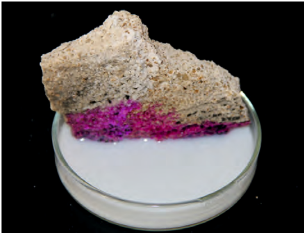
Abbildung 5: Violettfröbung (Phenolphthalein-Indikatorfröbung) des Steins nach Aufnahme von CaLoSiL® E25.
